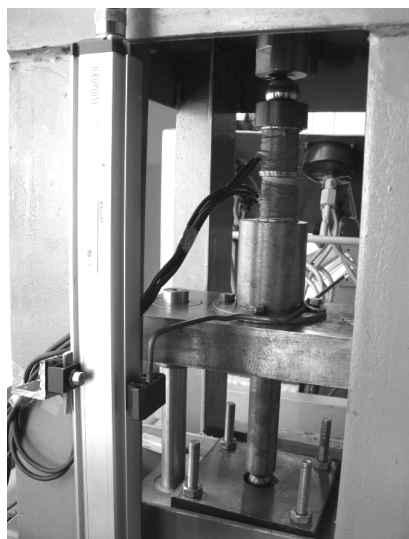
Рис. 3. Схема испытания на выдавливание сферической лунки
